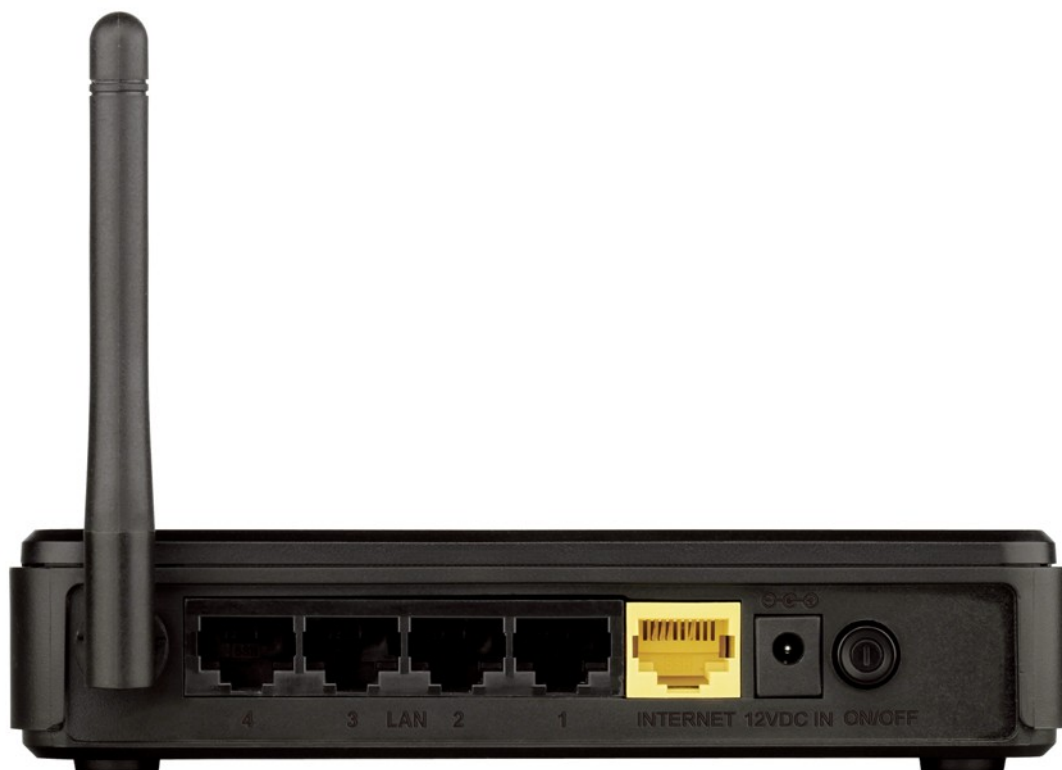
Рисунок 2. Вид задней панели DIR-300.
